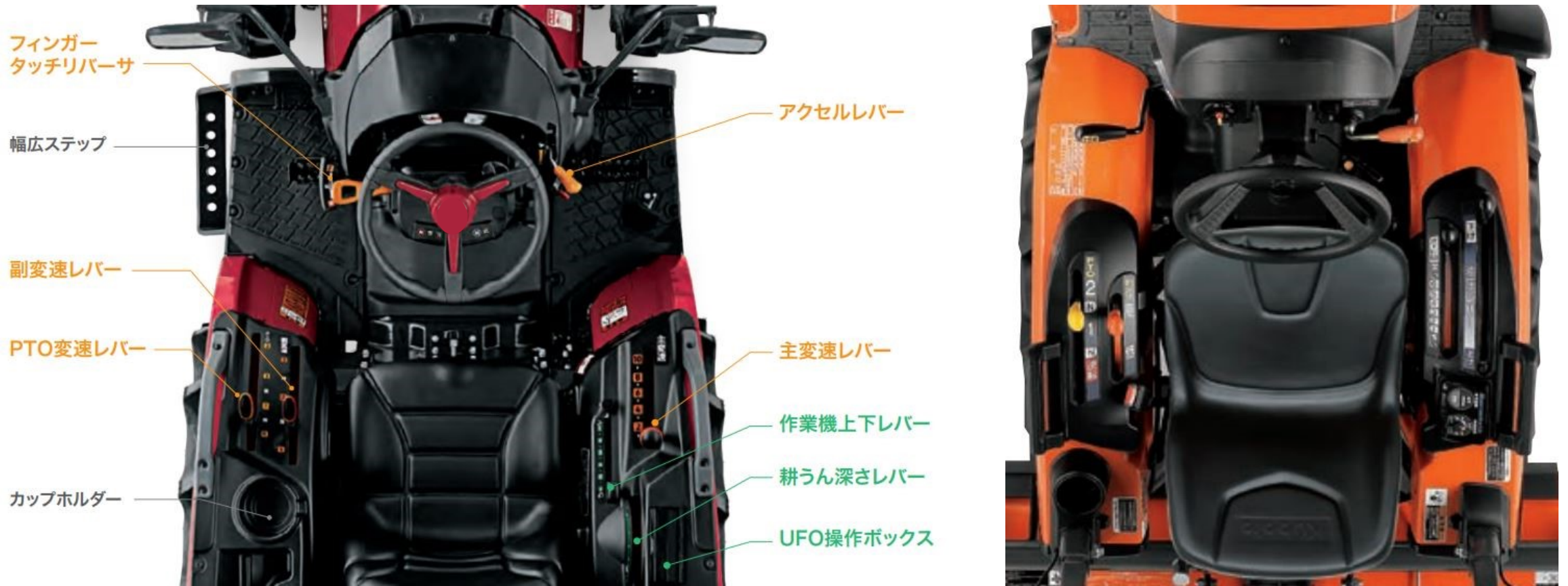
小型トラクタの運転席 (メーカーによって配置が異なる操作レバー類)
