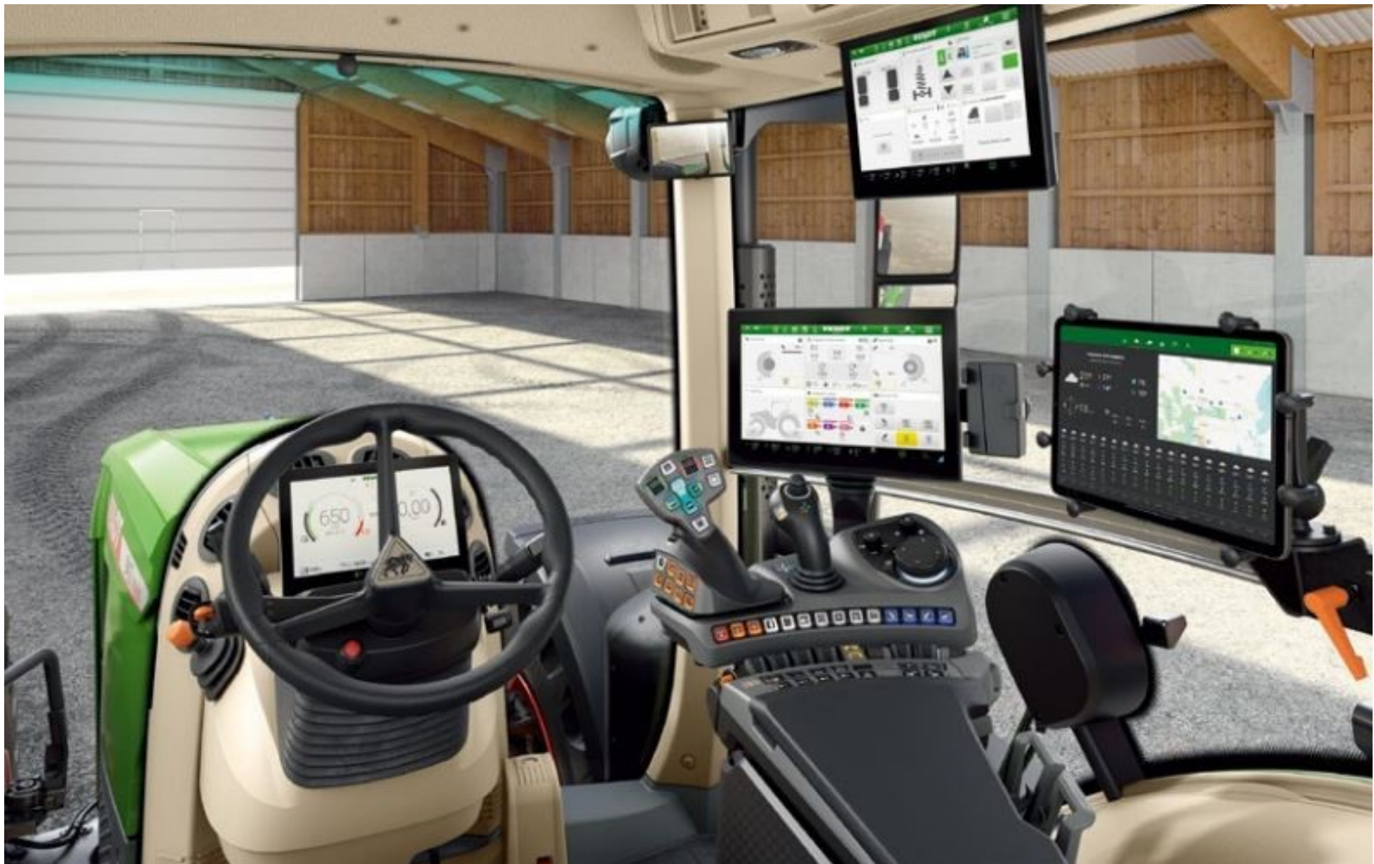
複数のモニターが並ぶ大型トラクタの運転席 (車速、作業機関係の操作はすべて右手に集中している。)
